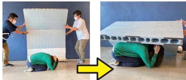
発砲スチロール製のブロック塀モデルを使って揺れによる倒壊を再現します。
